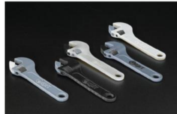
Clés à molette imprimées en 3D. (Source : Objet)
